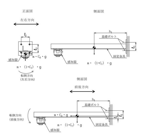
図 5-3 防湿型煙感知器の計算モデル
