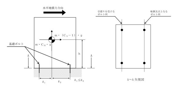
C<sub>V</sub>>1の応力評価モデル (短辺方向)
