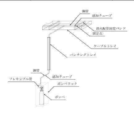
図 2-13 消火配管 (ケーブルトレイ消火設備) の概要図
