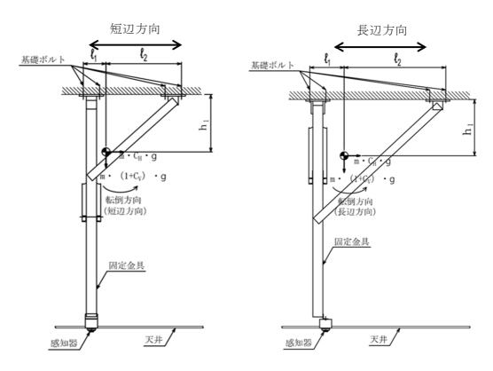
図 5-1 煙感知器, 熱感知器, 防水型熱感知器及び防爆型煙感知器①の計算モデル
