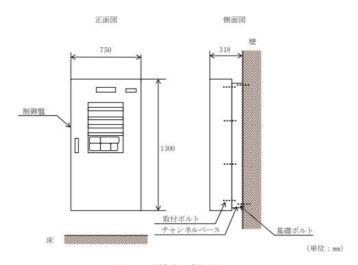
図2-12 制御盤の概要図
