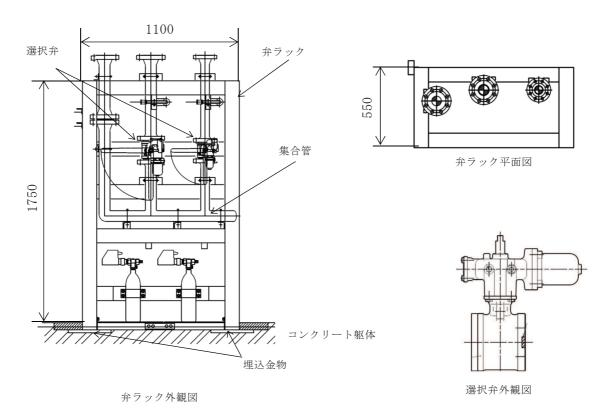
図2-11 選択弁の概要図
