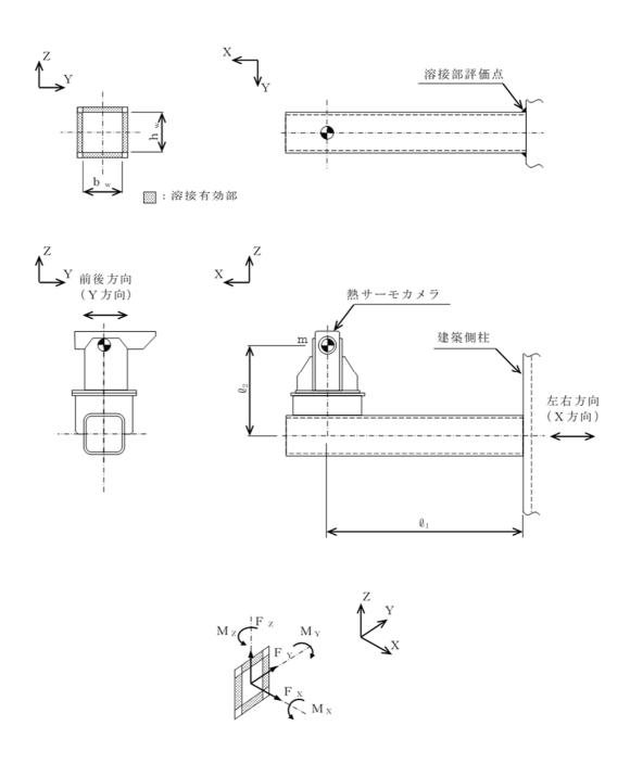
図5-6 熱感知カメラ 計算モデル
