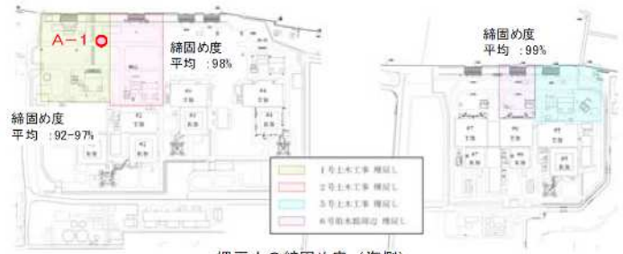
埋戻土の締固め度 (海側)
