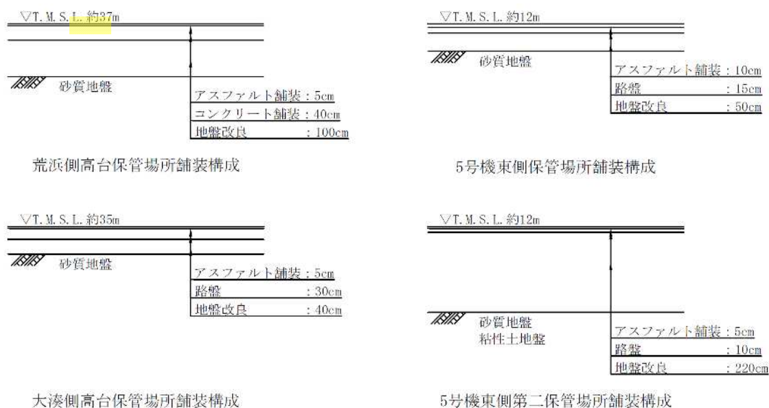
図 6-4 各保管場所の舗装構成
