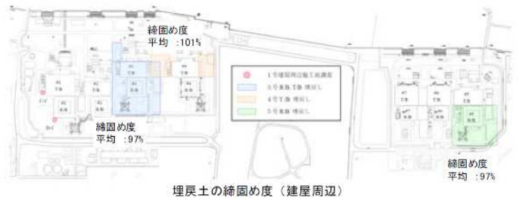
埋戻土の締固め度 (建屋周辺)
