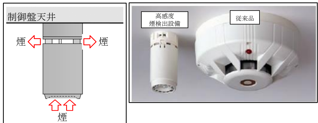
第3-10図 高感度煙検出設備の概要
