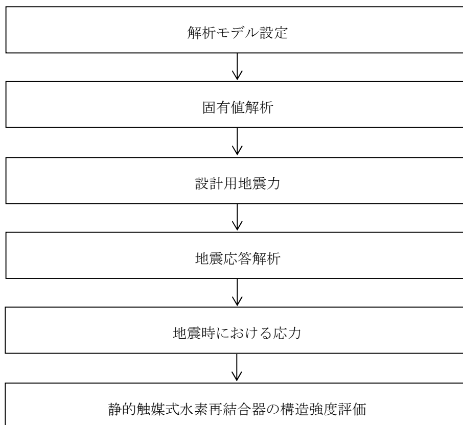
図2-1 静的触媒式水素再結合器の耐震評価フロー
