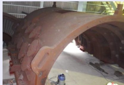
低圧内部車室
