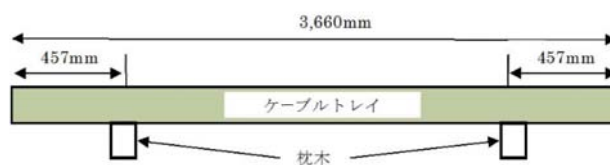
第2図 ケーブルトレイ設置方法
