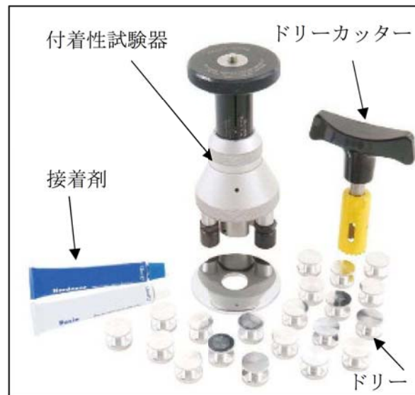
図 プルオフ法の試験機材（例）
