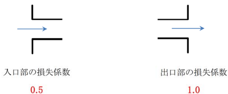
図1 入口部及び出口部の損失係数
