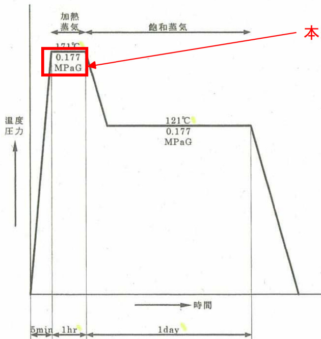
図 1.2.3-3 蒸気暴露試験条件-2 (BWR プラントの LOCA 時の原子炉格納容器外の雰囲気気を包絡)
