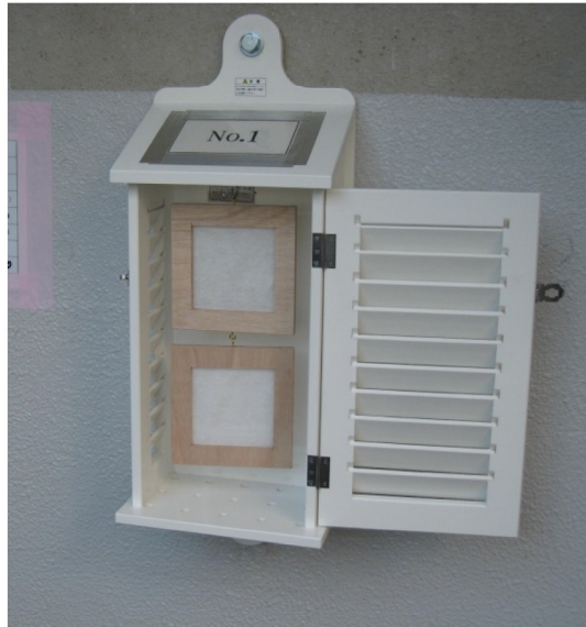
図 4. 1. 4-2 飛来塩分捕集器 (ドライガーゼ法)
