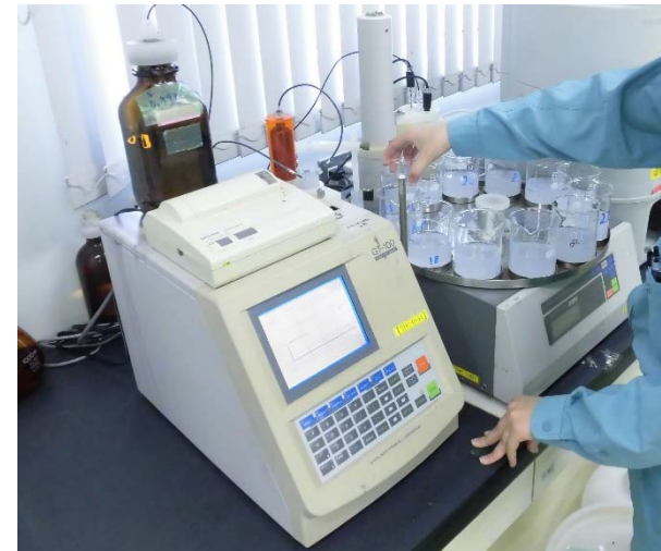
塩分浸透の点検状況
