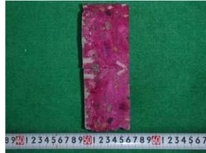
中性化の点検状況
