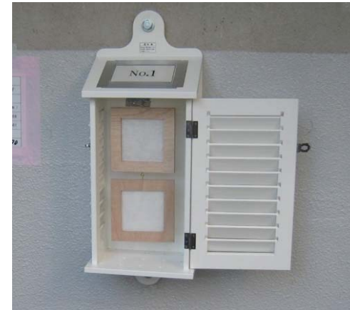
飛来塩分捕集器(ドライガーゼ法)
