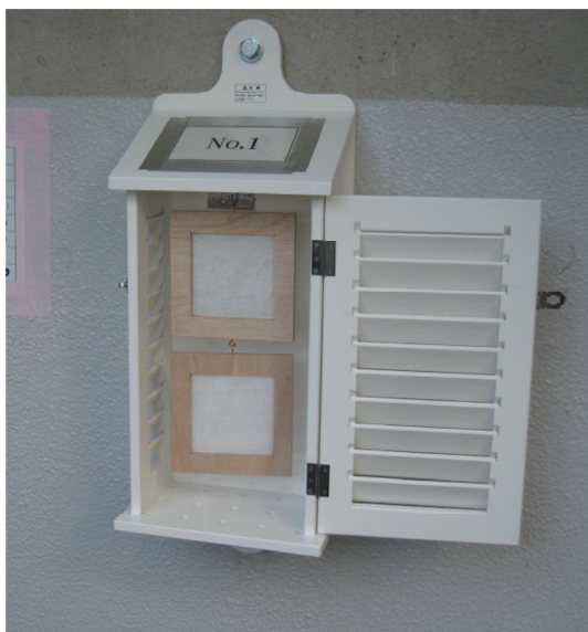
図 4. 1. 4-2 飛来塩分捕集器 (ドライガーゼ法)
