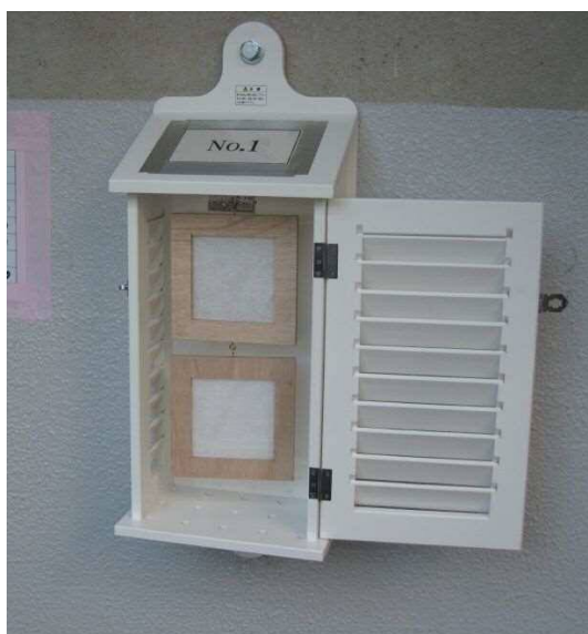
図 4. 1. 4-1 飛来塩分捕集器 (ドライガーゼ法)
