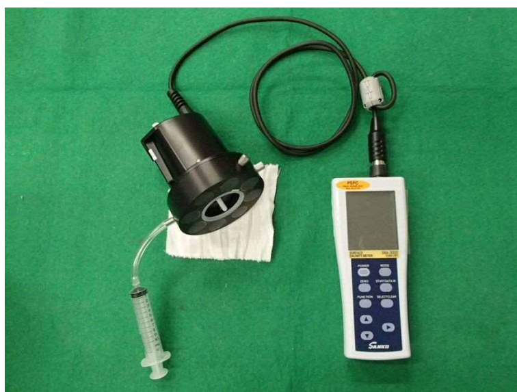
図 4. 1. 4-2 表面塩分量測定器 (ポータブル表面塩分計)
