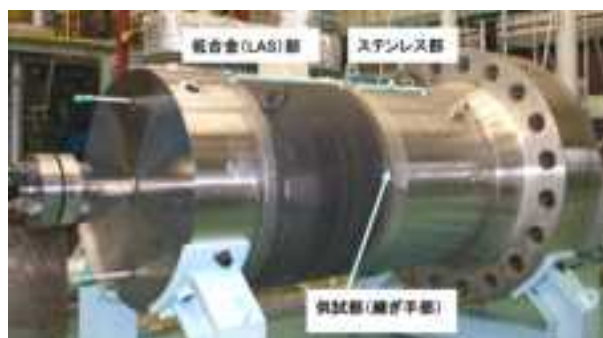
図 2.3.2-12 JNES NSC 出口管台モデル試験体 51
