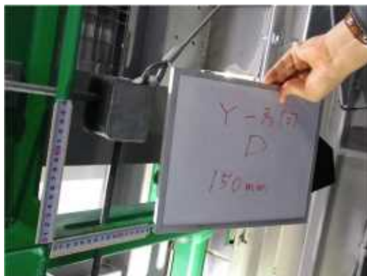
図 3-4-5 復元力機構の変形の例 (Y 方向加力, 150mm 時点)
