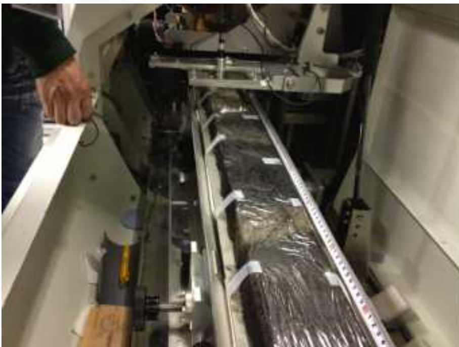
図 7.15 : XRF 分析装置にコアをセットした様子
