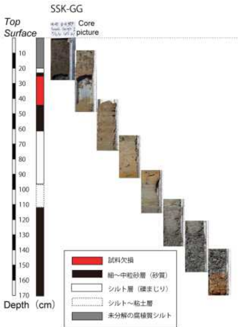
図 7.5 : 須崎市コア (Site 3) の地質柱状図およびコア写真.
