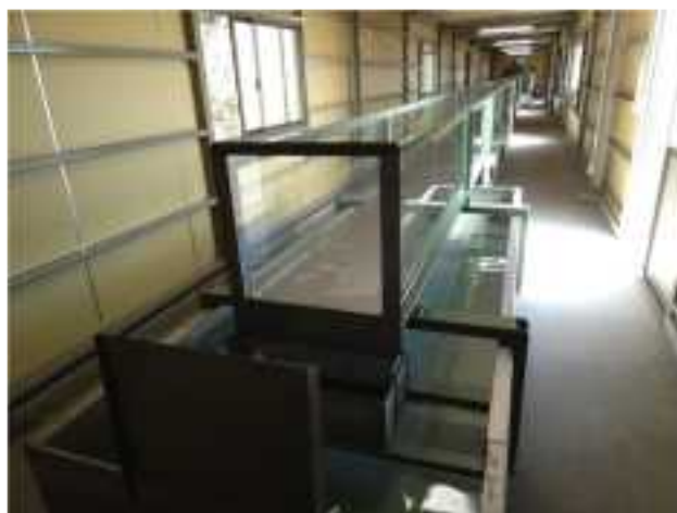
図 9-5 下流水槽及び実験水路下流端
