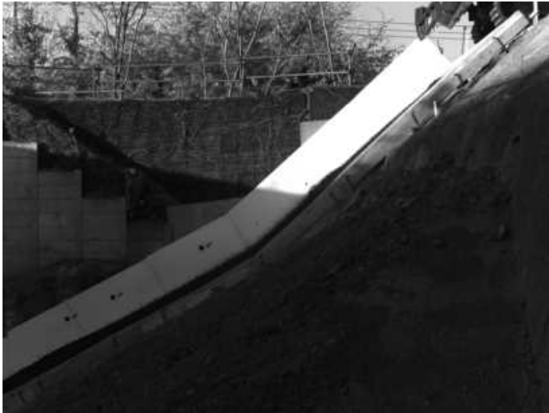
図 9. 1. 255 土砂模型の流動状況(1.93 秒後)
