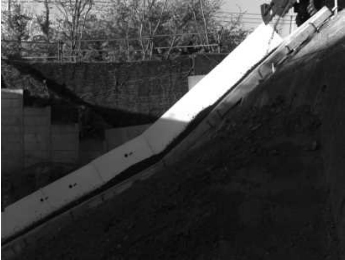
図 9. 1. 254 土砂模型の流動状況(1.3 秒後)
