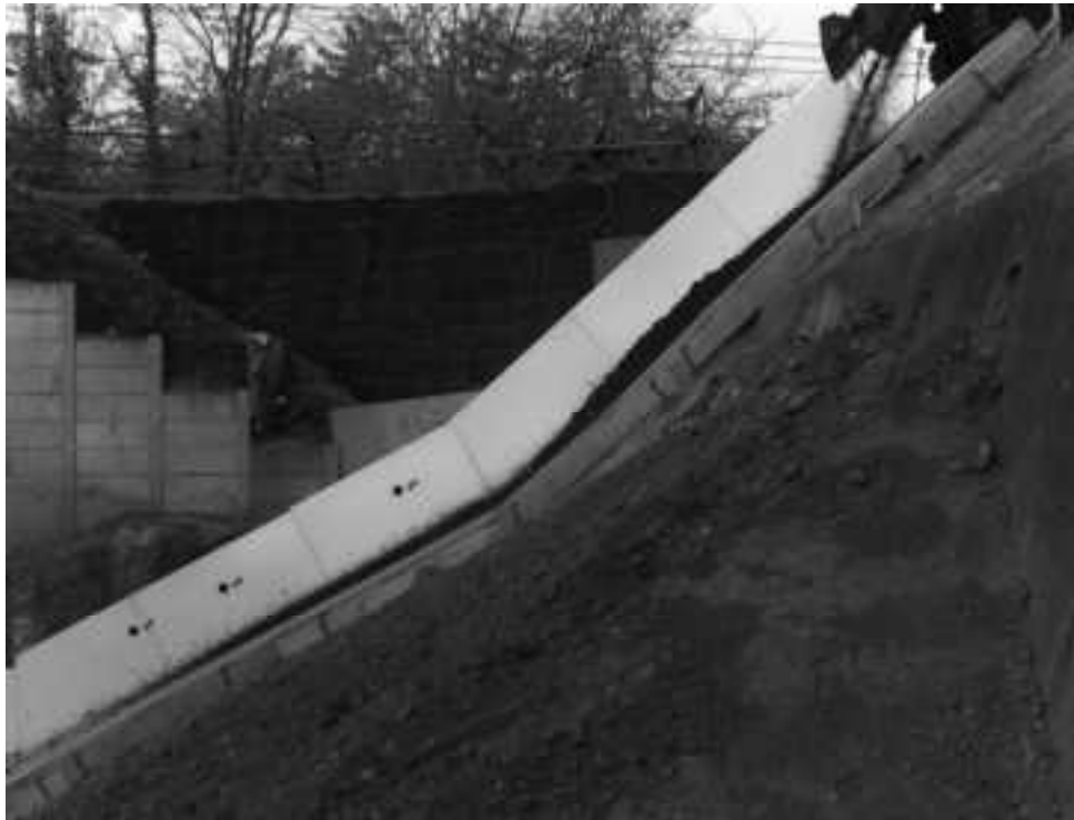
図 9. 1. 280 土砂模型の流動状況 (1.07 秒後)
