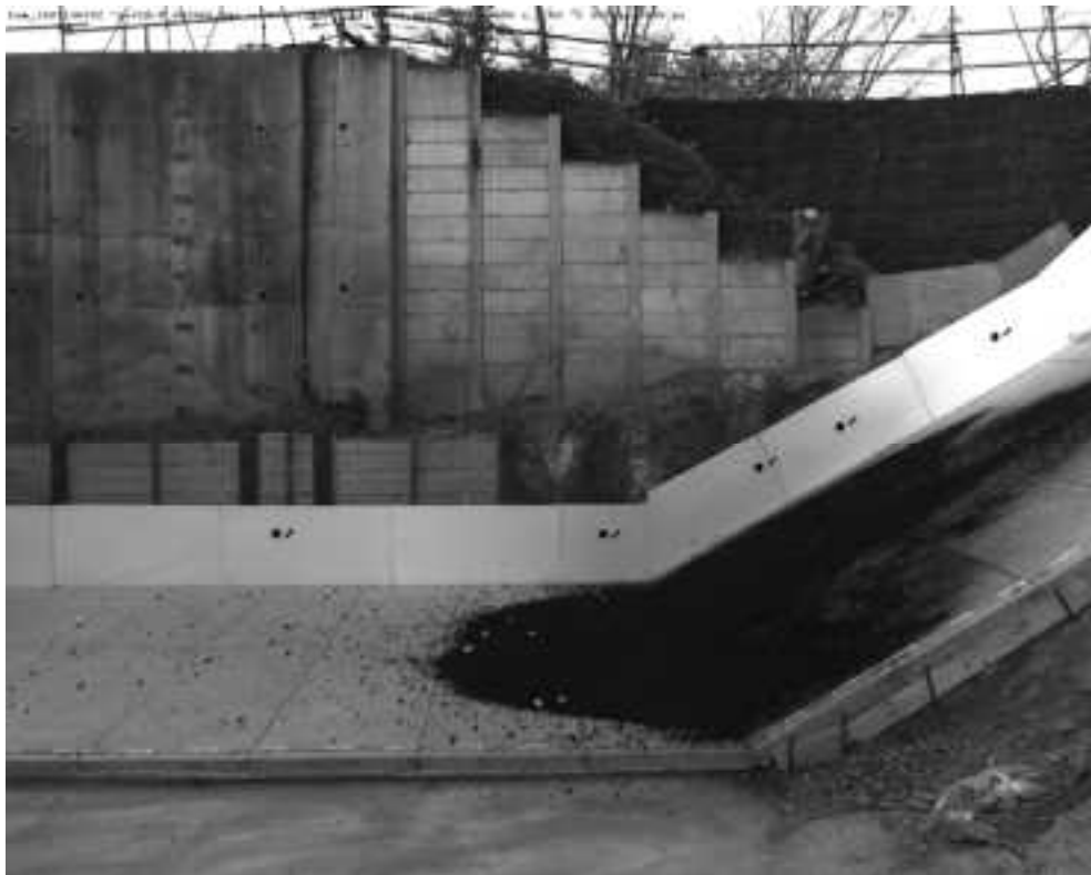
図 9. 1. 281 土砂模型の流動状況 (2.0 秒後)
