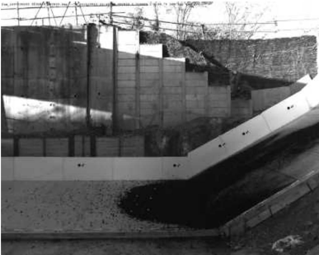
図 9. 1. 257 土砂模型の流動状況(2.0 秒後)
