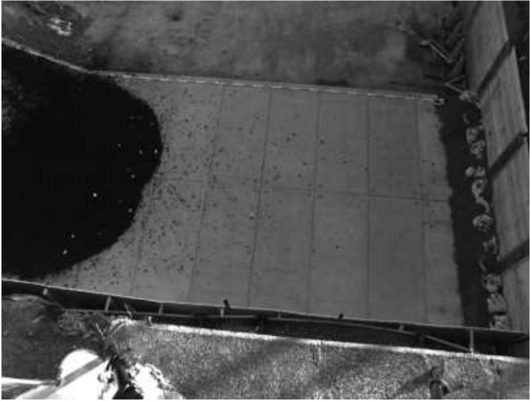
図 9. 1. 266 土砂模型の流動状況 (0. 67 秒後)
