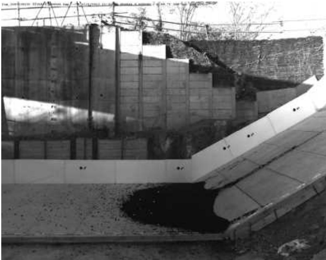
図 9.1.259 土砂模型の流動状況(6.0 秒後)
