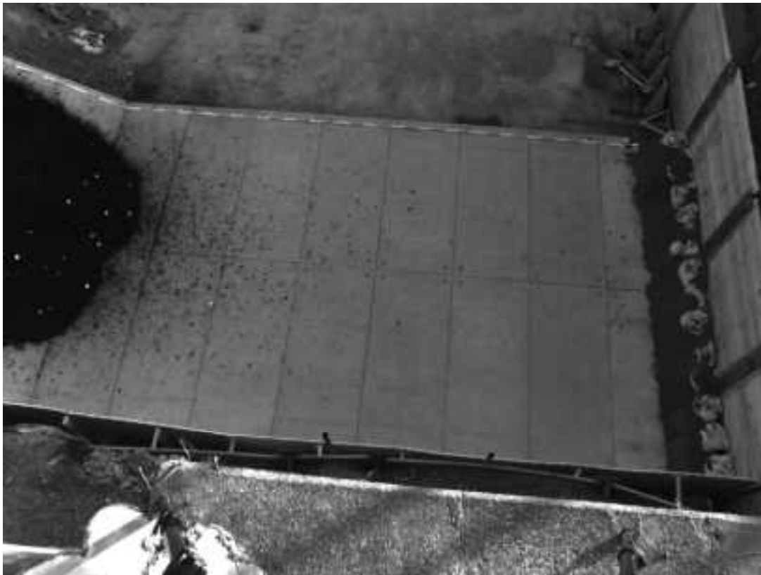
図 9. 1. 265 土砂模型の流動状況(0.3 秒後)
