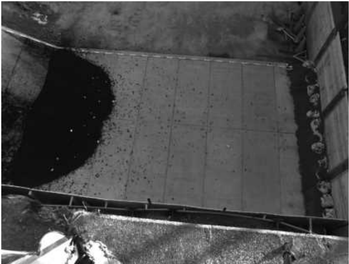
図 9. 1. 267 土砂模型の流動状況 (1. 12 秒後)
