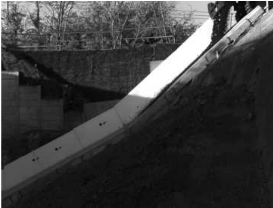
図 9. 1. 252 土砂模型の流動状況(0 秒後)
