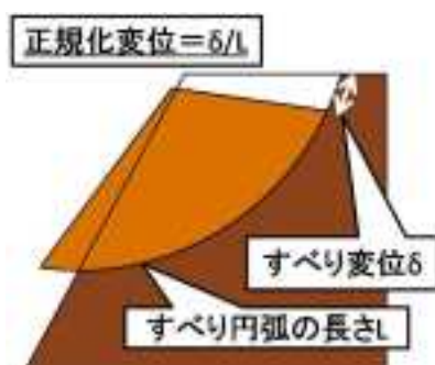
図 9.2.2 斜面模型の崩壊形態
