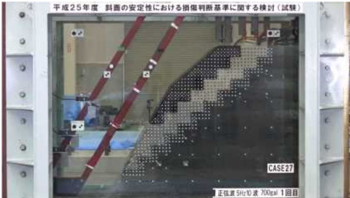
写真 6.2.7 Case27 変形し始める瞬間の様子 (11.238 秒)
