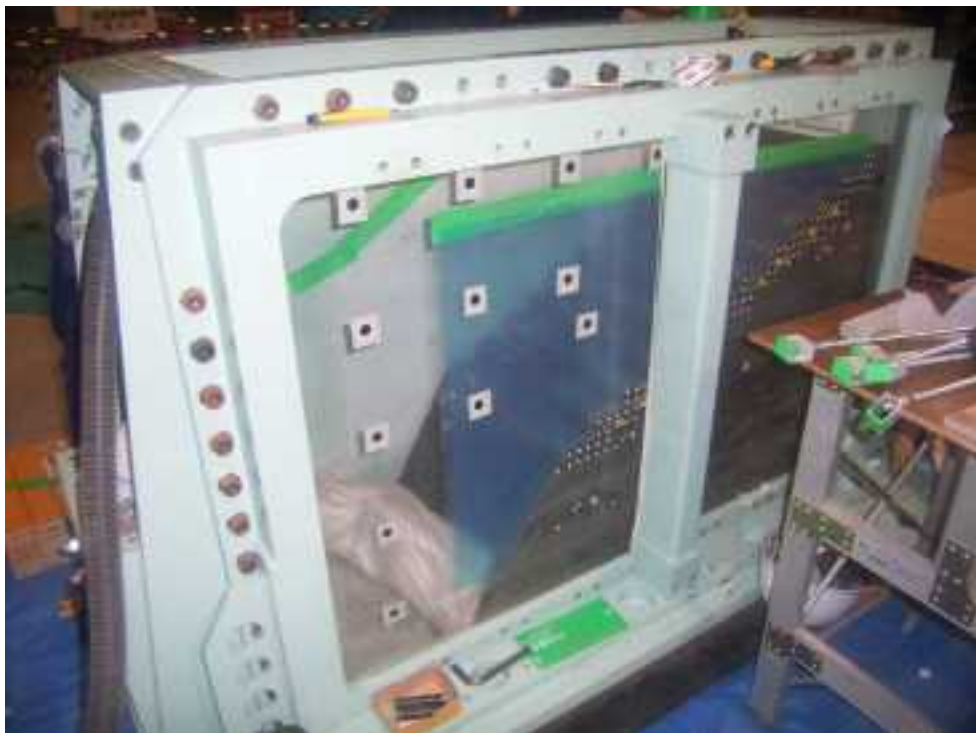
写真 3.1.5 摩擦低減層シート貼り 2
