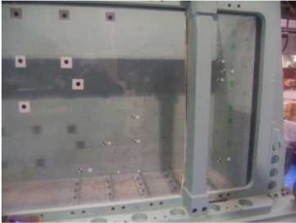
写真 3.1.6 土槽底面に剛結した等辺山形鋼
