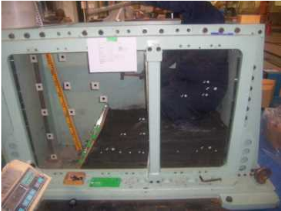
写真 3.1.8 基盤層の作製状況
