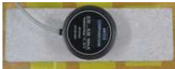
図 1.3-3 Quickline-30 を用いた測定例
