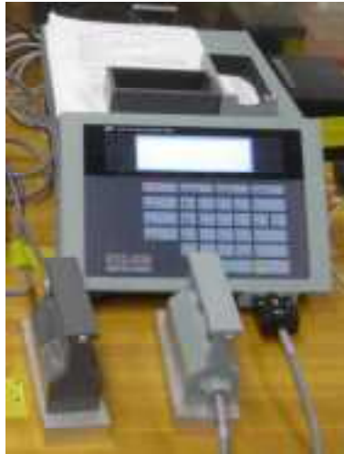
図 1.3-1 迅速熱伝導率計を用いた測定例
