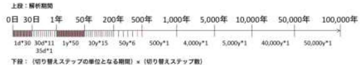
図 2.1.3.1-5 空洞有りの期間および埋戻し後の流速場の切り替えステップのイメージ。 ただし、シナリオ1のみ、50～500 年後は50 年間隔で9 ステップ。
