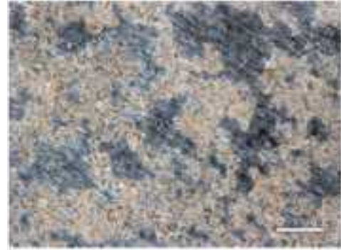
写真b 残留応力緩和処理を施した面 腐食のみでき裂はない
