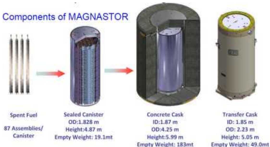
図 2.1.7-4 Kuosheng プログラムの“MAGNASTOR”の構成要素 50
