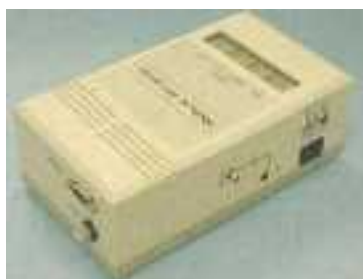
図 2.1.2-28 アルゴンナ国立研究所が開発した初期の音速利用漏えい検出器(長さ約 13cm)
