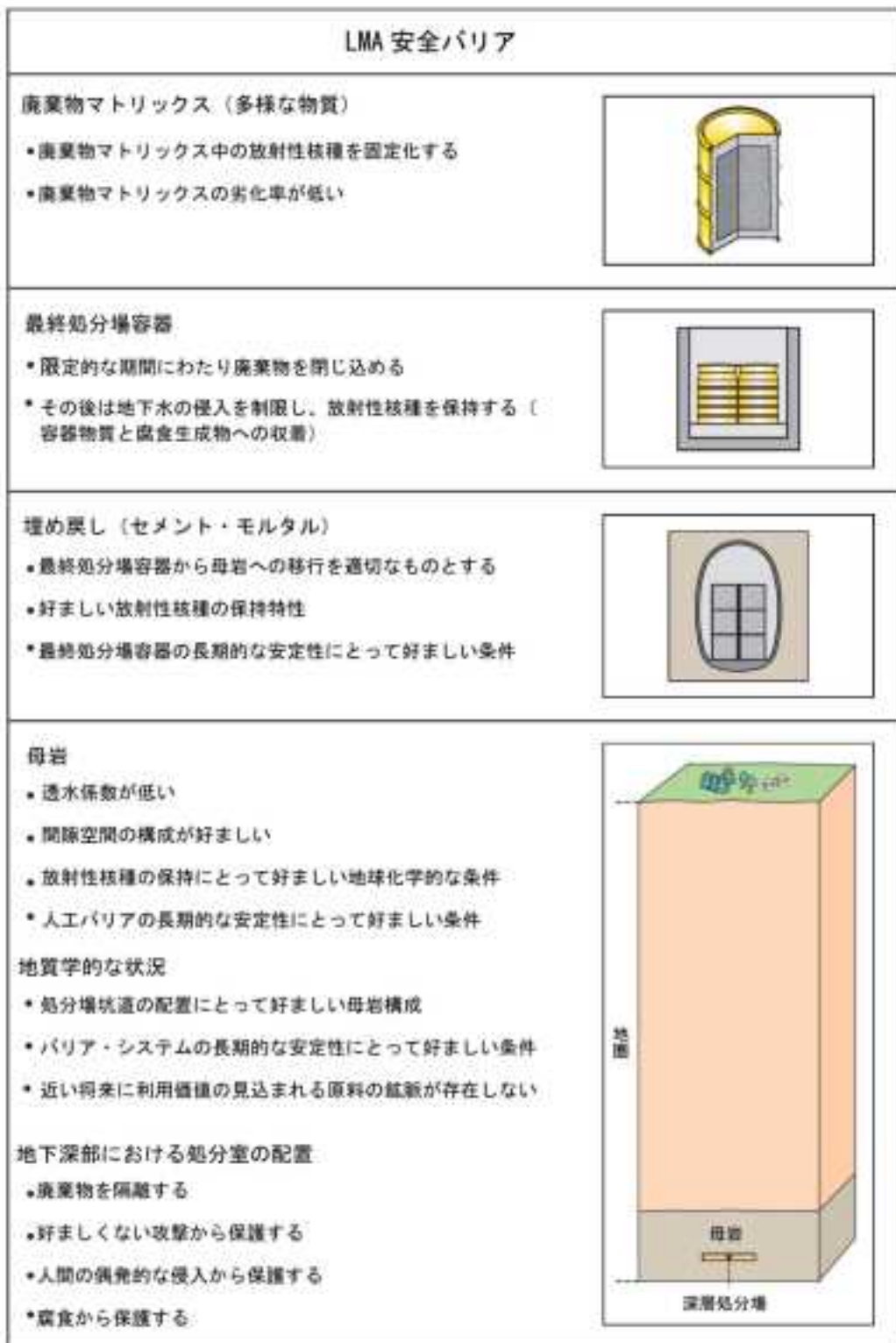
図 3.5-4 高レベル放射性廃棄物に長寿命中レベル放射性廃棄物を併置処分する場合の多重バリアの概念図
