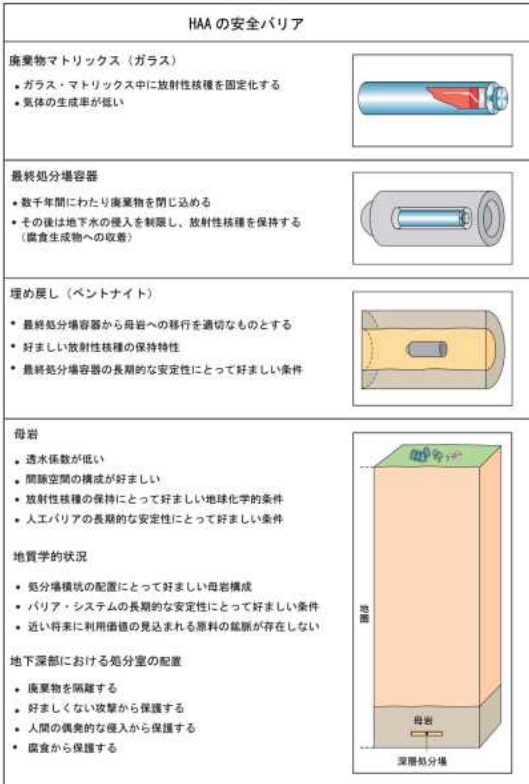
図 3.5-3 高レベル放射性廃棄物におけるガラス固化体の多重バリアの概念図
