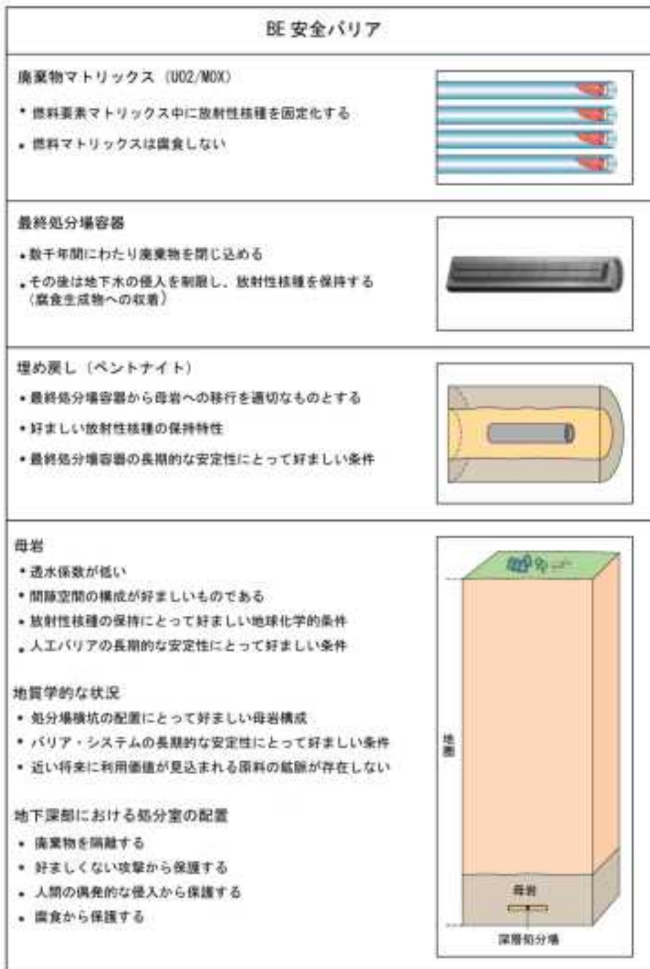
図 3.5-2 高レベル放射性廃棄物における使用済燃料の多重バリアの概念図
