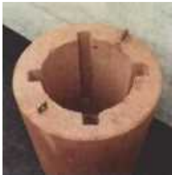
図 3.8-5 コンクリート製円筒容器の例 (type1)
