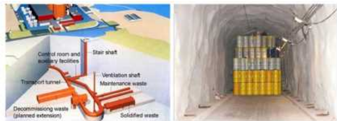
図 3.4-6 ロヴィーサの低中レベル放射性廃棄物処分場概念図（左）。右の写真は坑道内にある低レベル放射性廃棄物の入ったドラム缶。
