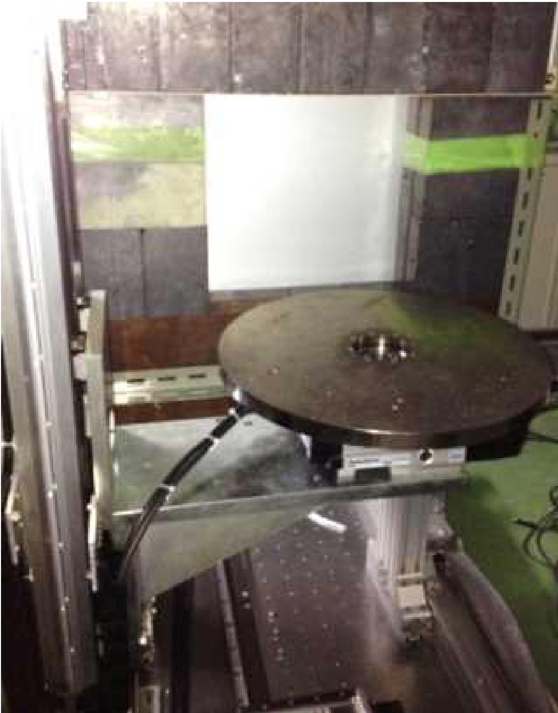
図 3-13 X線 CT 設備の回転試料台とフラットパネル
