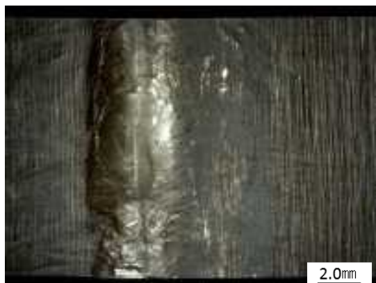
(a) ノズル側 DEPO、ハザック (倍率：20)
