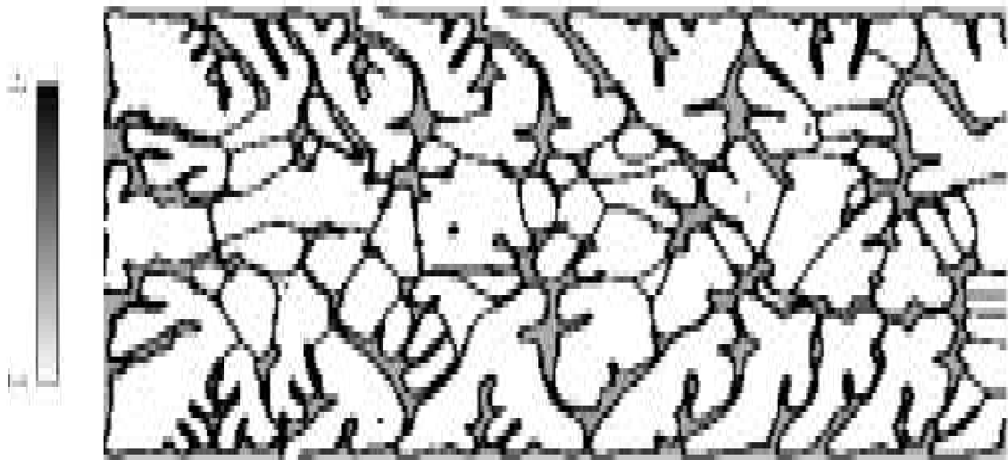
図 6 ANL-51 の凝固完了組織
