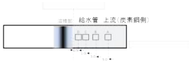
給水管内面の SEM 観察箇所 (ノズル側)
