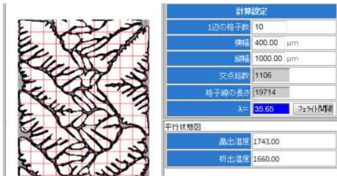
図 3.1.3-59 MICRESS フェライト間隔導出
