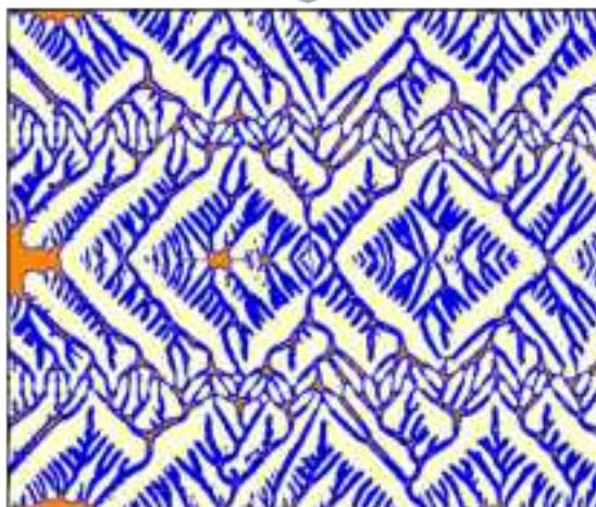
図 3. 1. 3-25 Fモードの方位関係と組織の形成過程
