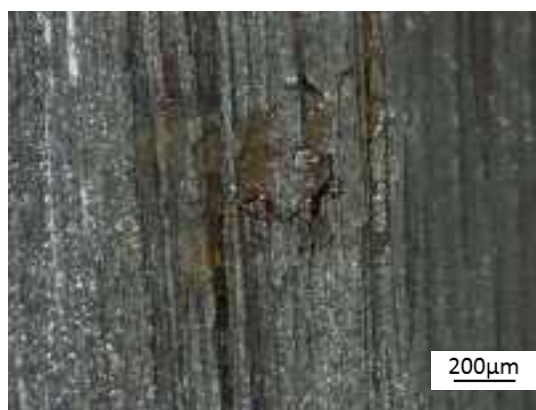
(b') ノズル側 HAZ 拡大 (倍率：200)
