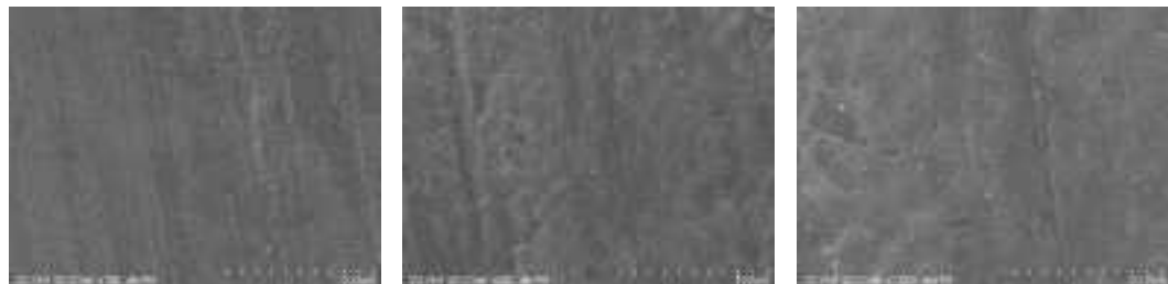
図 3.2.3-9 下降管内面の SEM 観察結果 (ノズル側)
