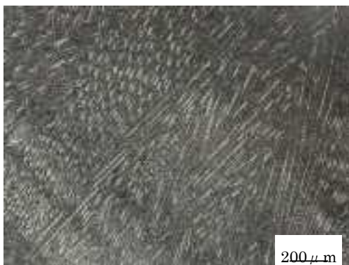
図 3.2.3-42 給水管マイクロ組織観察結果 (DEPO、インコネル 82T、内面から 1/4t)
