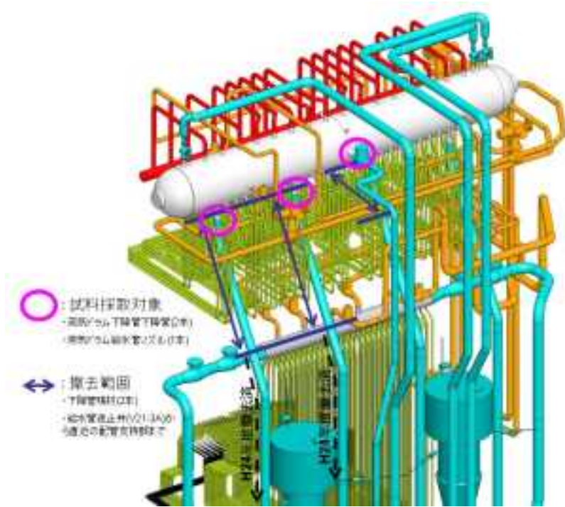
図 3.2.3-1 A ループ下降管及び給水管ノズルセーフエンドの内面観察及び浸透探傷試験箇所
