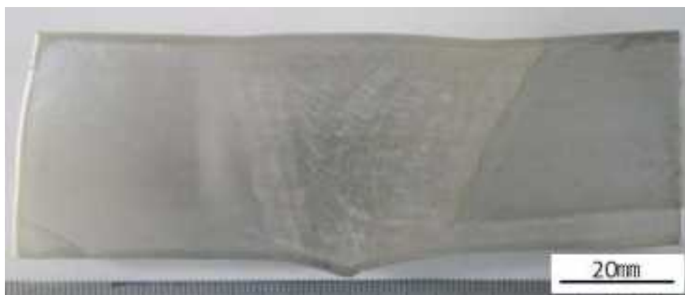
図 3.2.3-18 下降管の溶接部マクロ全体像
