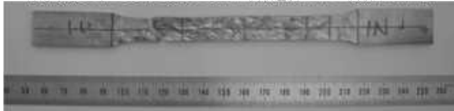
図 28 実機材 引張試験後の試験片の様子 (2/4)
