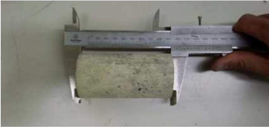
図 3.4.2-153 ノギスによる長さ測定の様子
