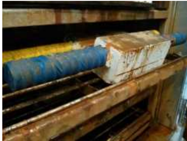
図 3. 4. 1-67 ひび割れを有するモルタル供試体の塩水噴霧試験の様子
