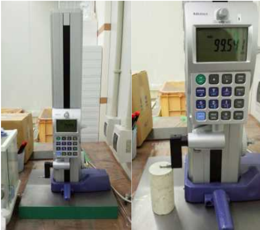
図 3.4.2-152 ハイトゲージ全体(左)と長さ測定の様子(右)
