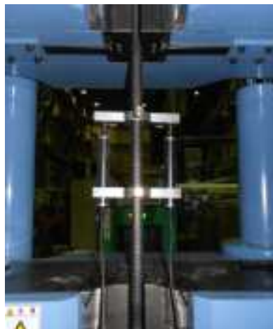
図 3. 4. 1-70 引張試験状況
