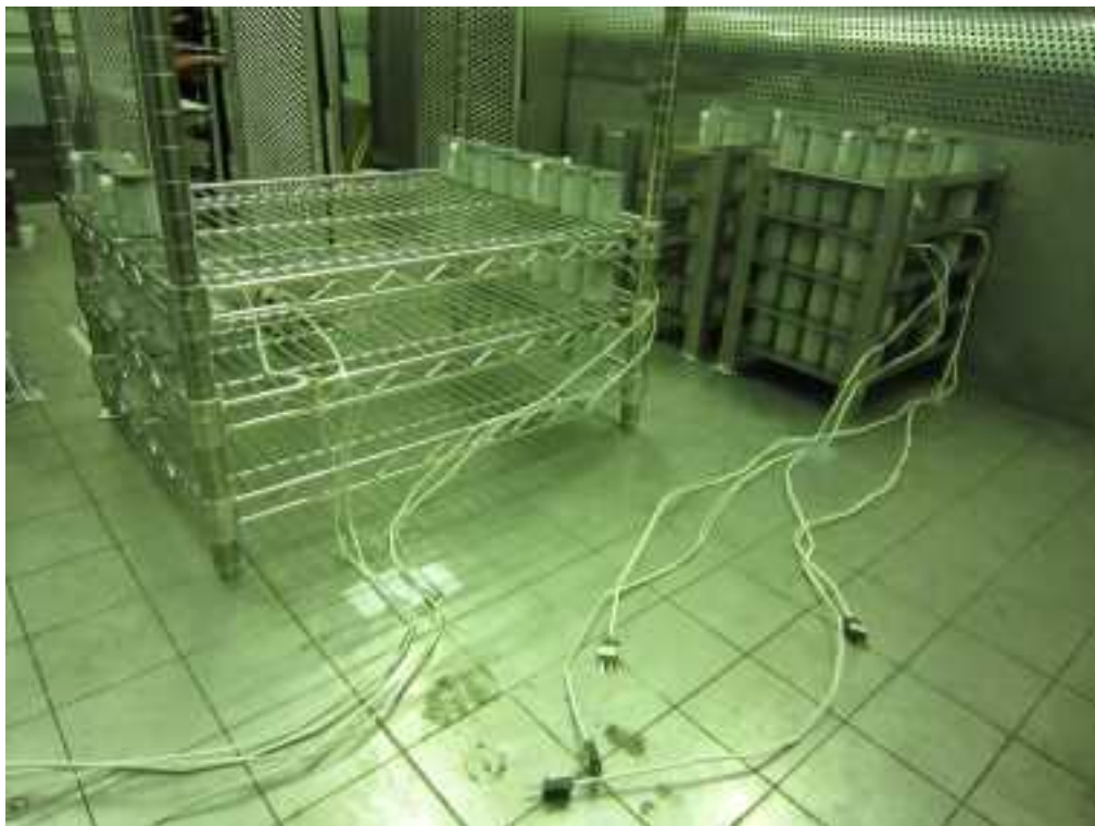
(b) 線量計配置状況 (2)
