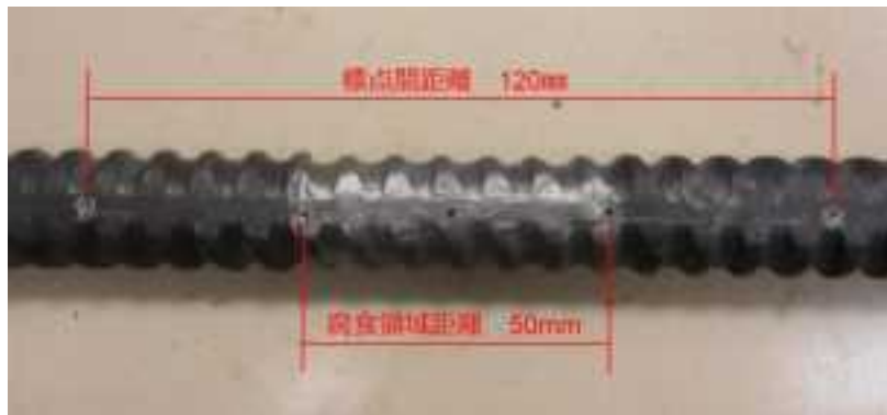
図 3. 4. 1-69 標点作製状況
