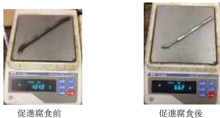
図 3. 4. 1-129 D10 裸鉄筋の促進腐食試験前と終了後
