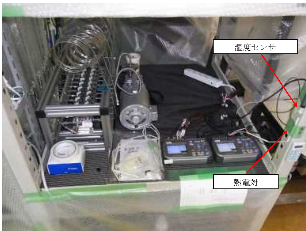
図 3. 4. 2-24 照射室外湿度センサ及び熱電対設置箇所
