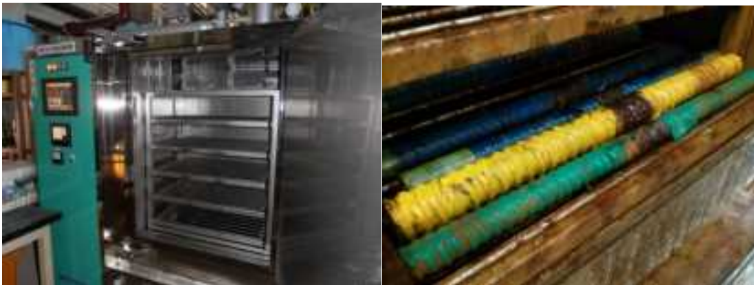
図 3.4.1-66 塩水噴霧試験の様子
