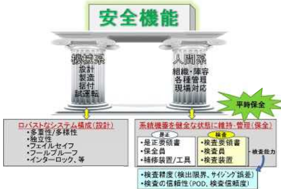
図 3. 2. 3-11 機械系の安全機能を担保する設計と保全
