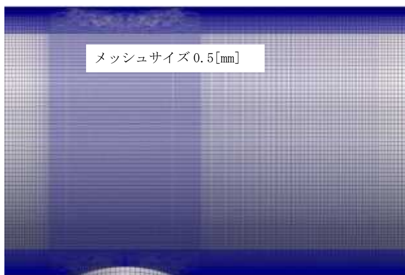
図 3.2.4-114 配管合流部のメッシュ拡大図
