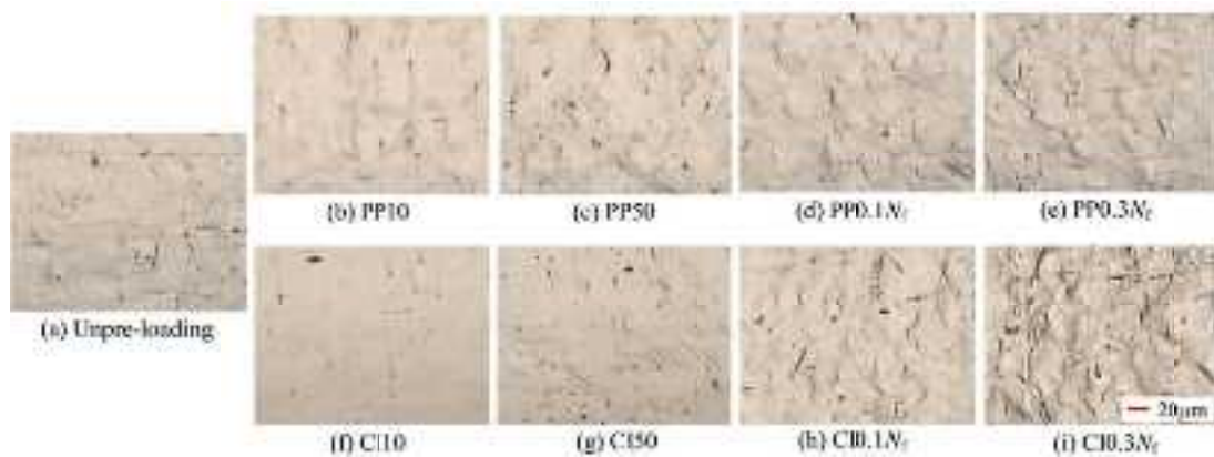
図 3.2.4-64 高サイクル疲労試験後のき裂観察結果
