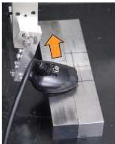
図 3. 2. 3-242 ブロック試験体へのプローブ配置
