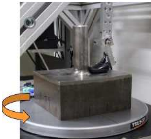
図 3. 2. 3-241 BMI 試験体へのプローブ配置
