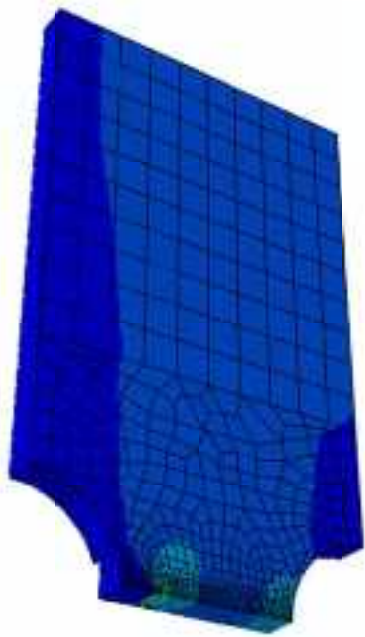
図 3. 2. 1-25 切欠き試験片の応力拡大係数の算出
