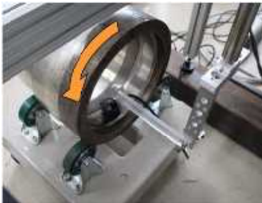
図 3. 2. 3-239 配管試験体へのプローブ配置
