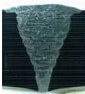
(a) 溶接部の断面マクロ写真の例 (b) 溶接部柱状晶組織モデル
