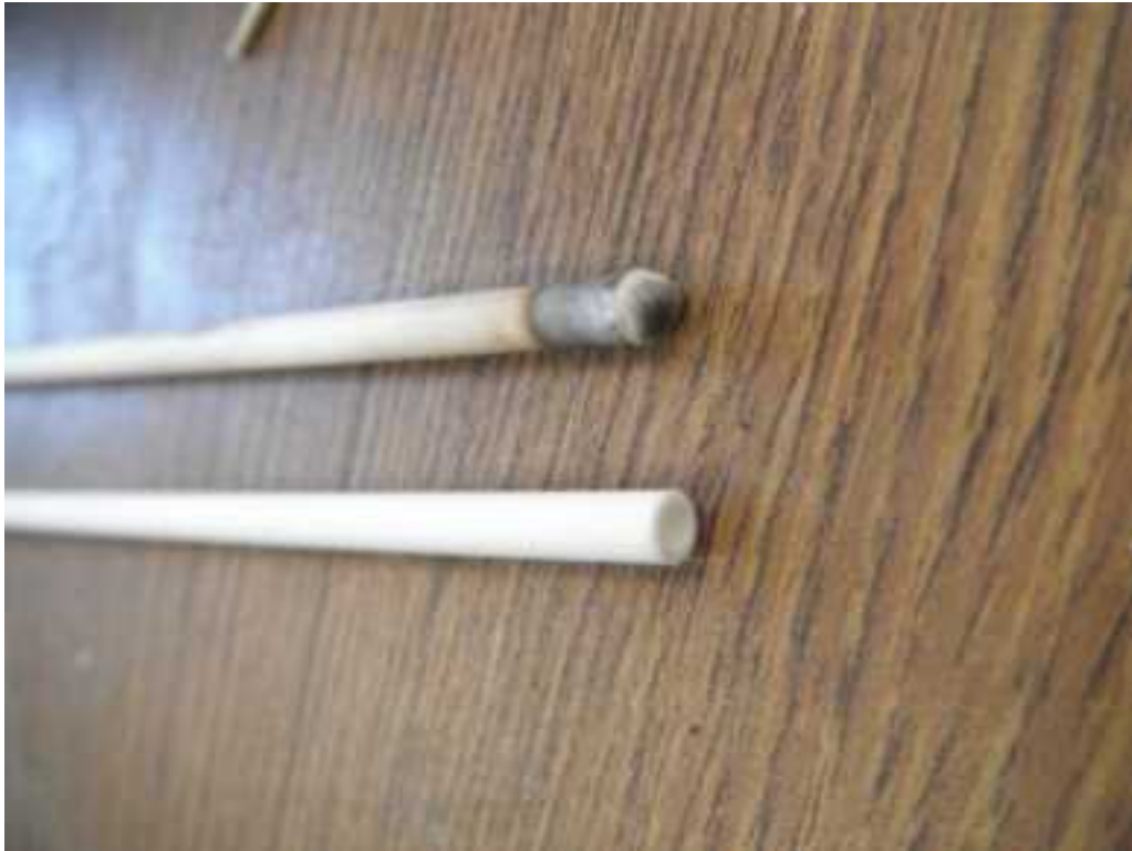
図 2. 1. 5-122 溶接前(下)と溶接後(上)のアルミナ細管
