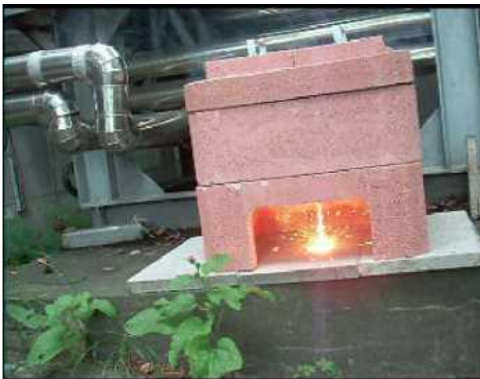
図 2. 1. 5-97 燃焼中のテルミット反応
