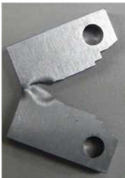
図 3.1.1-53 ポップインを生じて破壊した試験片の例
