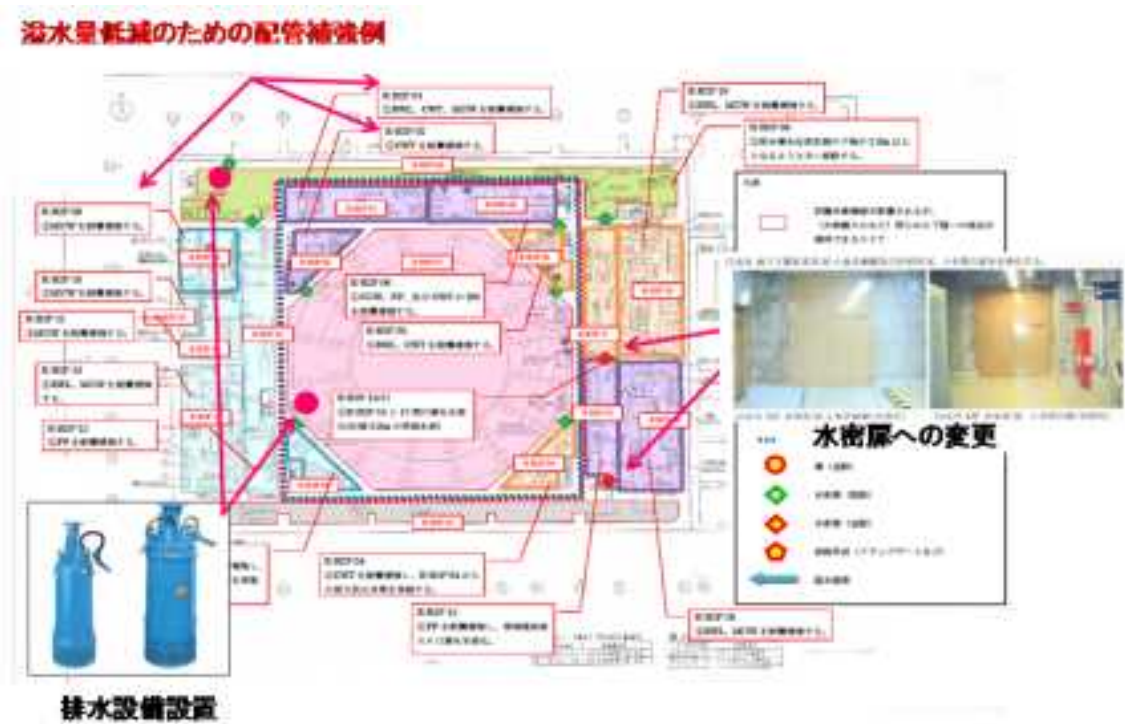
図 2.1.5-141 溢水量低減のための配管補強や漏洩検知器によって起動する排水設備
