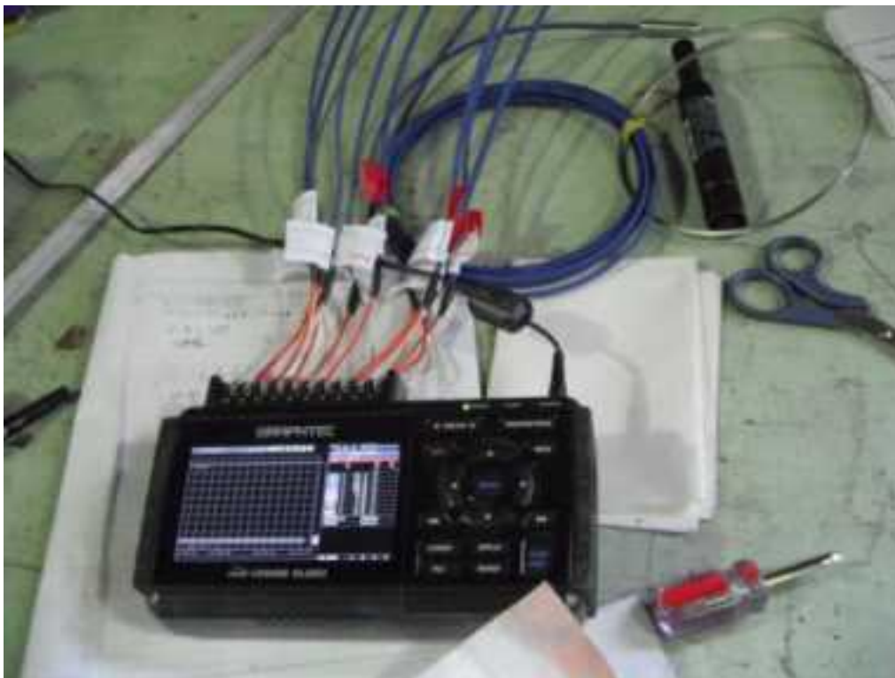
図 2.1.5-117 グラフテックデータロガー
