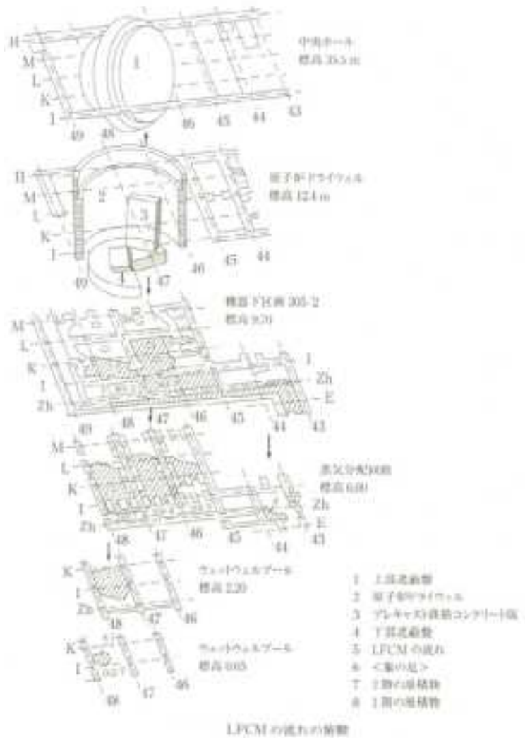
図 2. 1. 5-93 チェルノブイリ LFCM(溶岩状燃料含有物質)の流れの俯瞰図(出典：文献[1])
