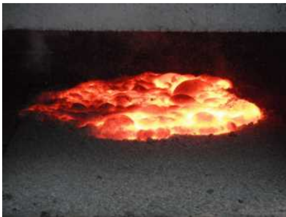
図 2. 1. 5-97 燃焼中のテルミット反応
