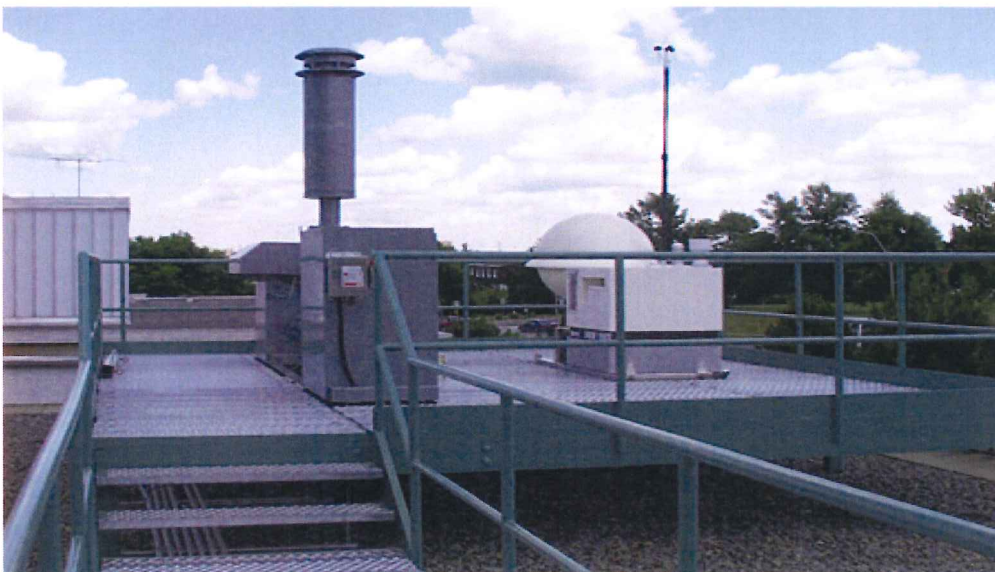
モニタリングステーションに設置された大気浮遊じん採取装置
