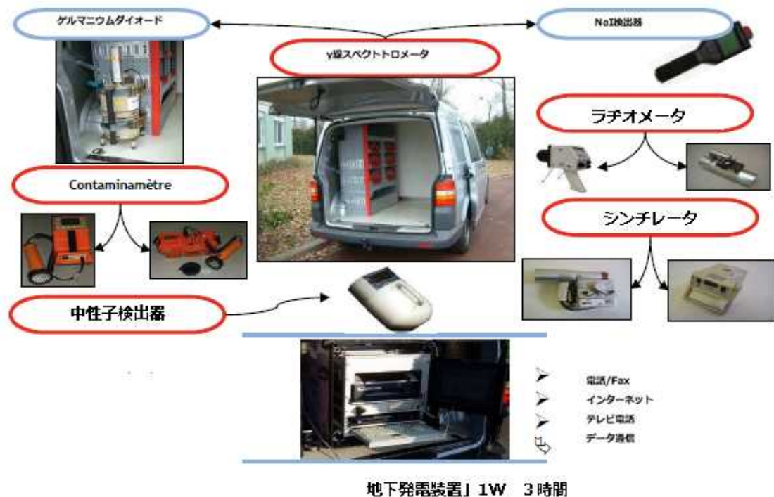
図 4.1- 10 緊急介入車両（軽量車両）及び搭載設備
