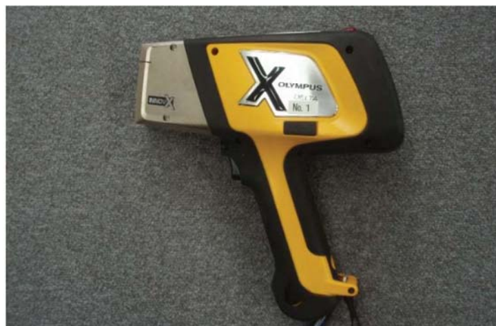
図 4. 1. 4 - 2 表面塩分量測定器 (蛍光 X 線分析計)
