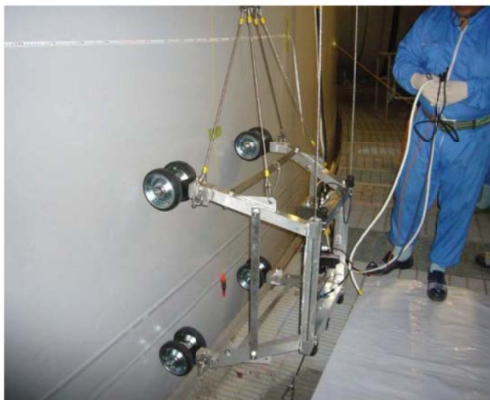
円筒部外面 遠隔目視用点検装置
