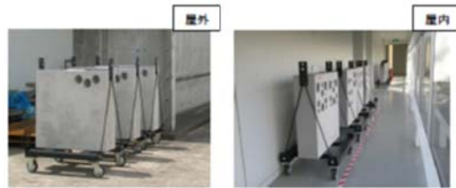
写真-1 壁試験体の暴露状況
