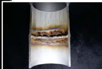
割れ箇所の裏側
