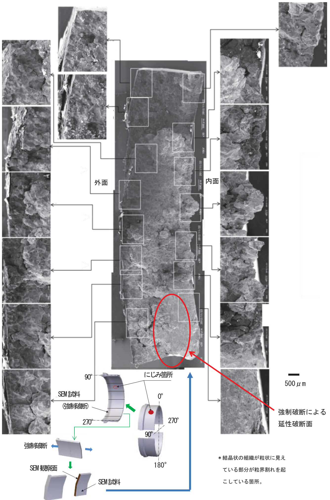
図 11 にじみ箇所近傍の強制破断後の破面観察結果
