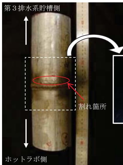
(a) 切出した配管
