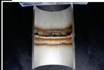
割れ箇所の裏側
