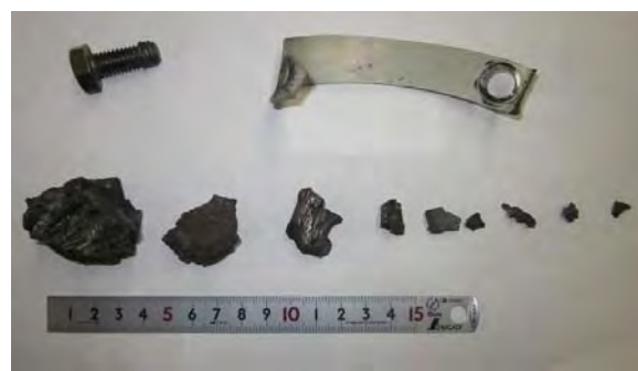
過給機付近にて発見された金属片
